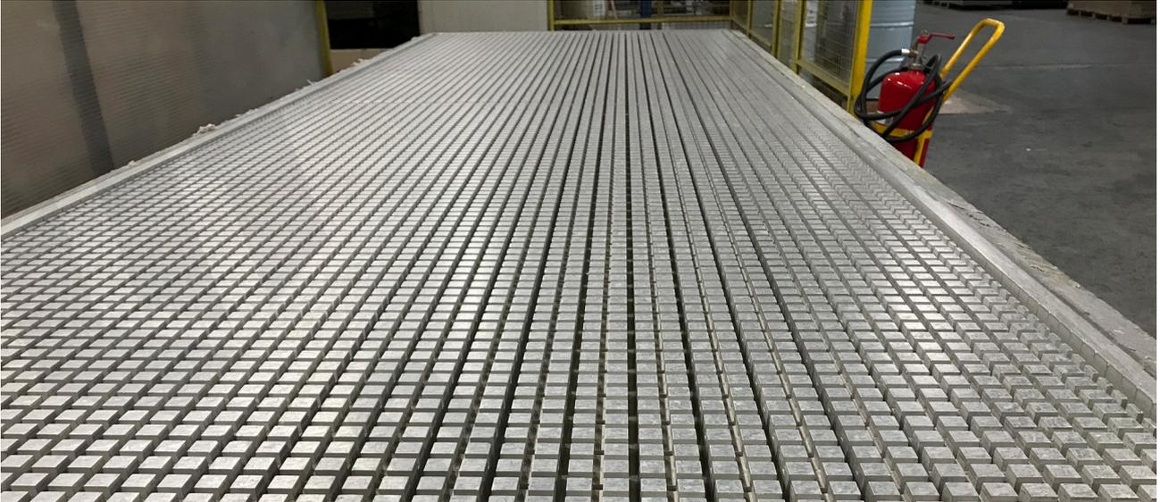
Im Anschluss können die GFK Roste auf die gewünschte Masse zugeschnitten werden - je nach Abmessung haben die zugeschnittenen GFK Roste offene oder geschlossene Maschen. Wenn umlaufend geschlossene Maschen gewünscht sind, muss zwingend Rücksprache gehalten werden. Die Zuschnittsart von GFK Rosten ist dem Holzzuschnitt ähnlich. Folgendes gilt es zu beachten:
