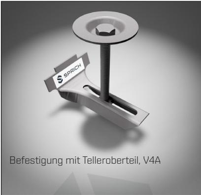
Zur Montage von GFK Gitterrosten können Befestigungen mit Telleroberteil eingesetzt werden. Die Befestigungen für GFK Roste ermöglichen – wie bei den Gitterrosten – eine einfache und schnelle Montage bzw. Demontage. Die Befestigungen erhalten Sie in Stahl feuerverzinkt und Edelstahl V4A.
