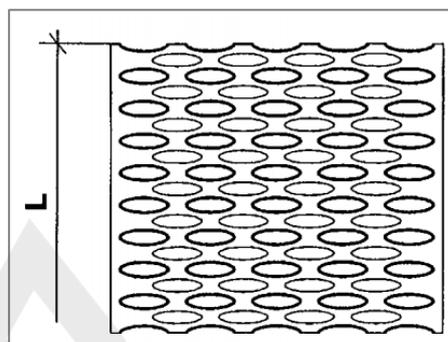
Le griglie in lamiera profilata senza fasce profilate in direzione «B» possono essere calcolate dal punto di vista statico solo in direzione «L».
