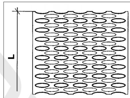
Blechprofilroste ohne profilierte Stege in Richtung "B" können statisch nur in Richtung "L" berechnet werden.
