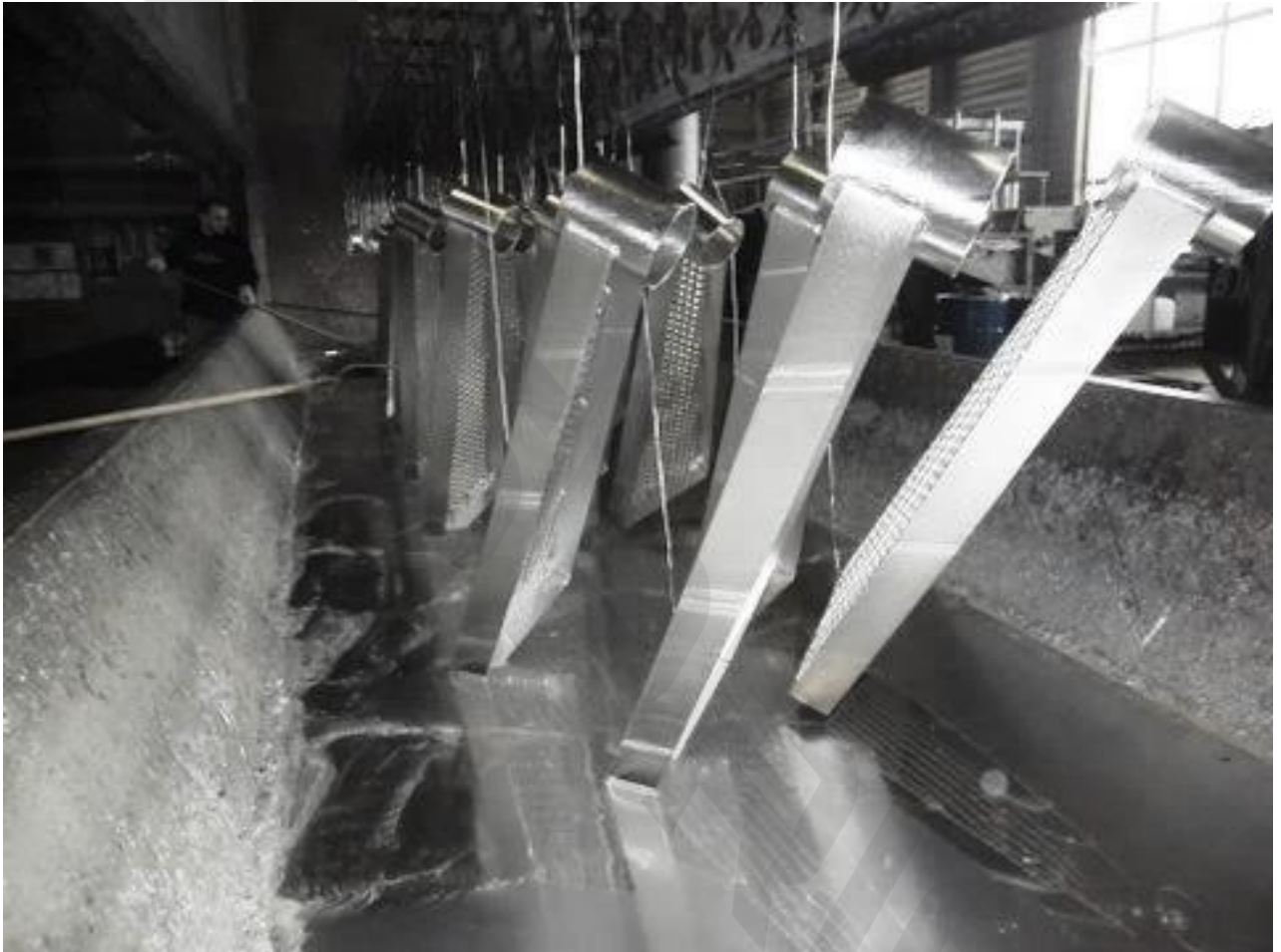
Bild: Beispiel Verzinkung von Spindeltreppenstufen
