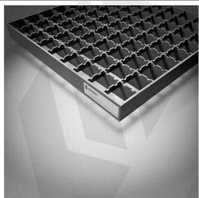
Unsere Gleitschutzroste bieten optimalen Halt unter jeder Bedingung (siehe Datenblatt Gleitschutz/Rutschhemmung). Einfacher Gleitschutz wird standardmässig auf dem Querstab profiliert. Doppelter Gleitschutz wird auf dem Querstab und Tragstab profiliert. Auf Wunsch kann der einfache Gleitschutz auch auf dem Tragstab profiliert werden.
